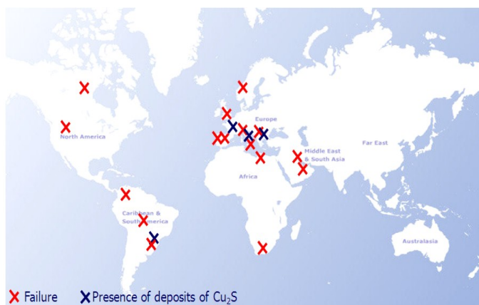
Fig.3 – Distribuzione mondiale di trasformatori in avaria per fenomeni di corrosione del rame
