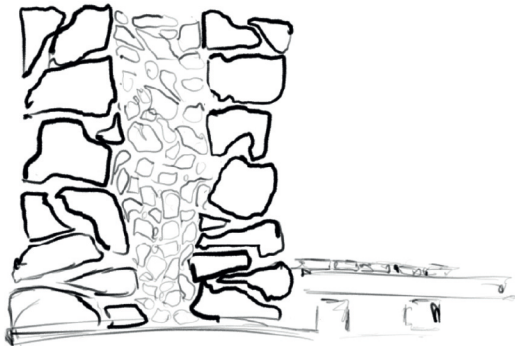
Muro a sacco
