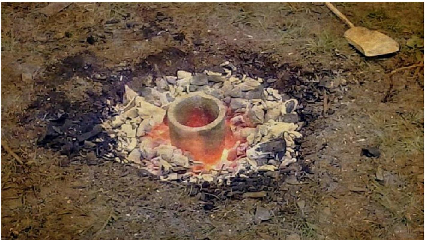
Un elemento molto importante era il *crogiolo*, un recipiente in argilla molto refrattaria (cioè che resiste alle alte temperature) munito di un apposito incastro per permettere all'artigiano di girarlo con una pinza, in modo da ruotare agevolmente il contenitore al momento della "colata" nella matrice.
