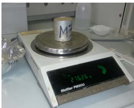
Foto 2 Prelievo campioni e pesatura in laboratorio per determinare la porosità del terreno
