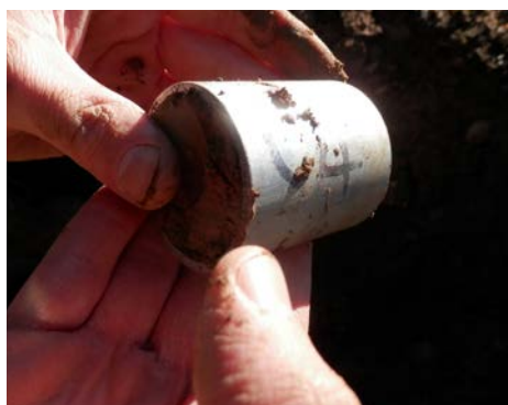
Foto 2 Prelievo campioni e pesatura in laboratorio per determinare la porosità del terreno
