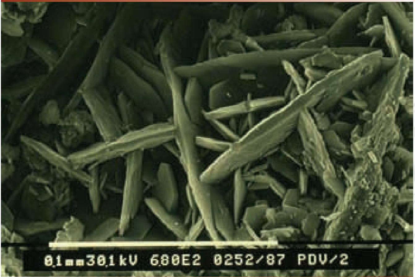
Figura 2 - Micrografia al SEM della crosta nera prelevata dalla Carità mostrante una micro-geode di cristalli geminati a ferro di lancia di gesso formatasi per reazione tra la calcite del marmo e l'acido solforico da inquinamento atmosferico.
