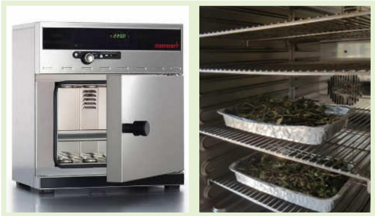
Figura 7: Essiccatore a ventilazione forzata utilizzato in Italia, DISAFA.
