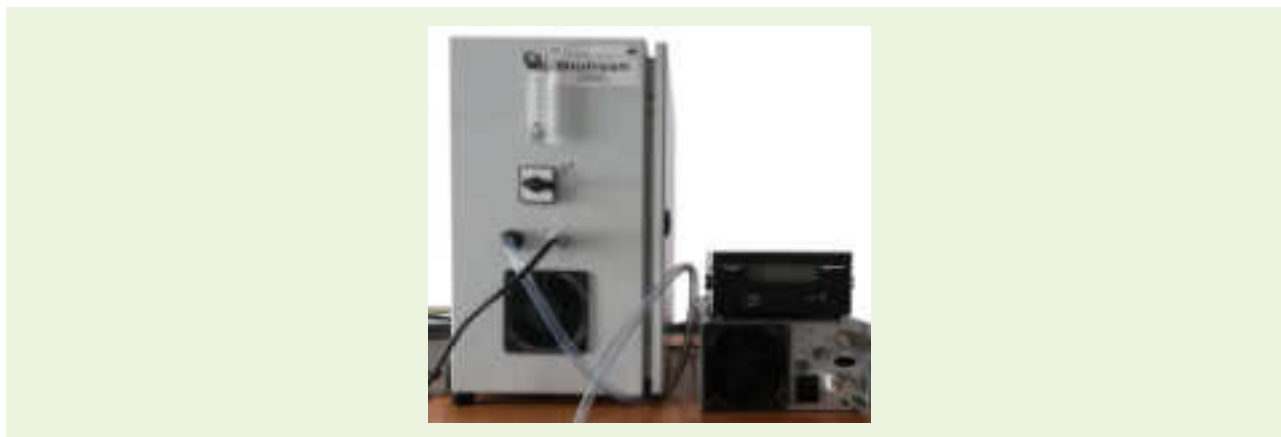
Figura 33: Generatore di ozono Biofresh LM-5 (sx) e sonda di misurazione dell'ozono Analyzer uv-100 (dx).
