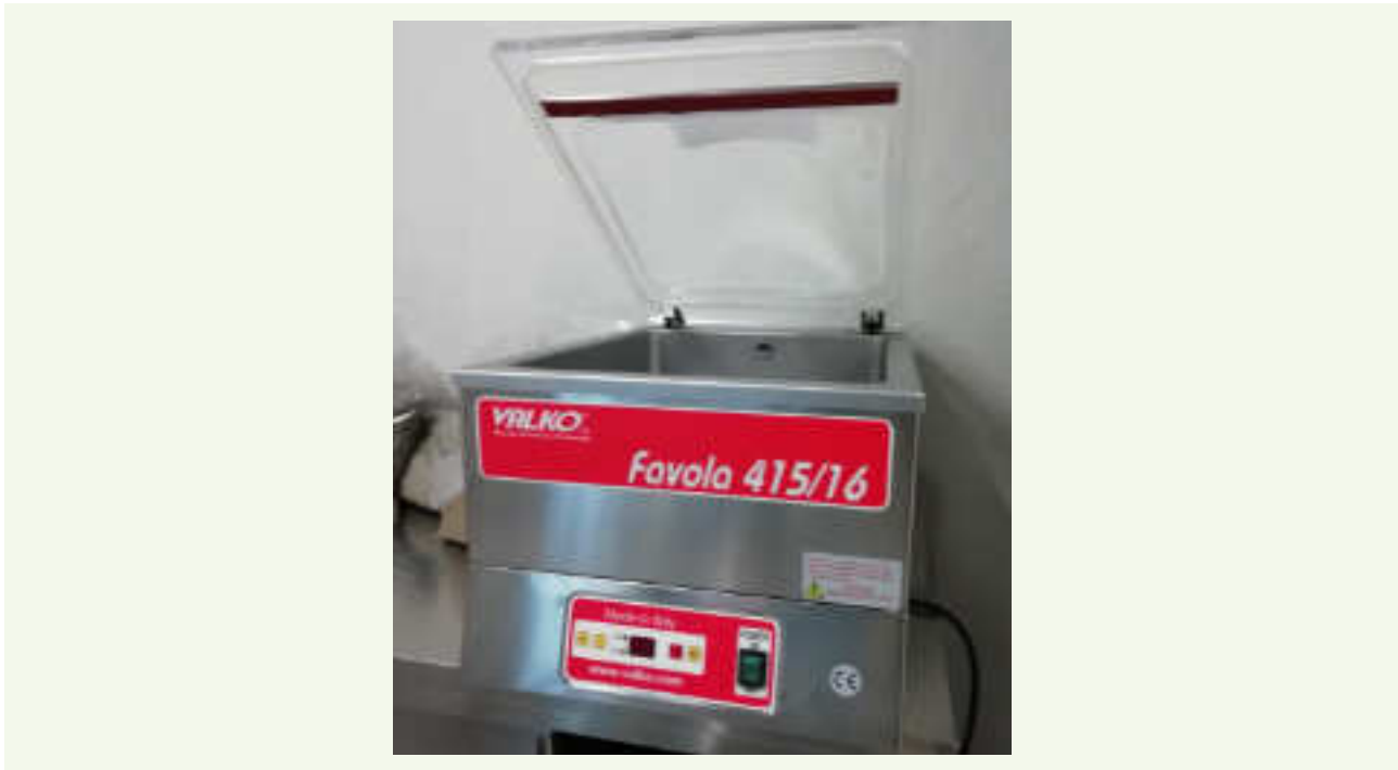
Figura 45: Termofardellatrice manuale con camera di sottovuoto compensato utilizzata per il confezionamento delle piante essiccate.
