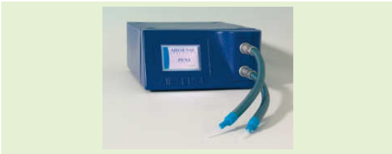
Figura 4: Naso elettronico PEN 3.
